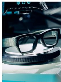
>1 Sensori integrati nella montatura di un occhiale per misurare parametri e movimenti dell'occhio. Set-up di test e sviluppo con modello di occhio realistico.
