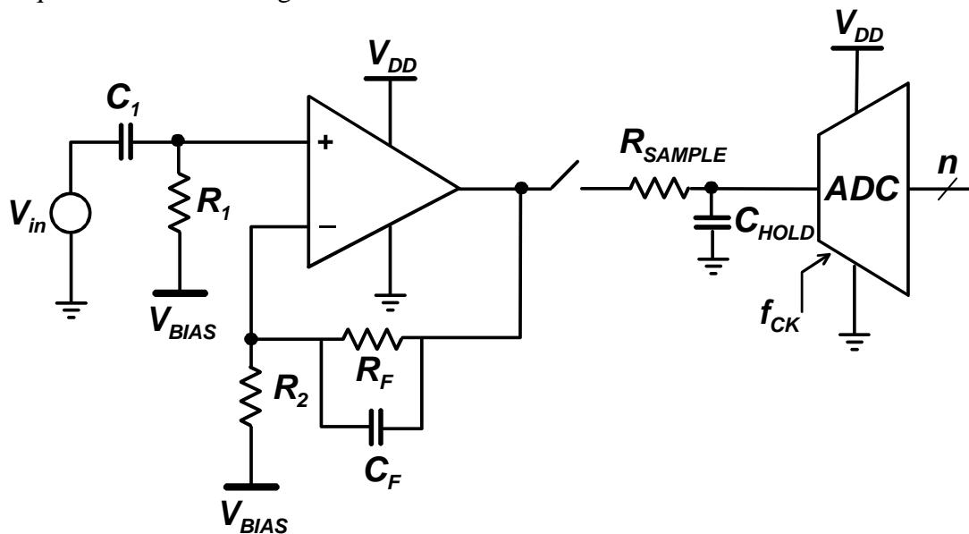
Si consideri che il segnale in ingresso,  $V_{in}$ , ha un'ampiezza massima di 10mV e che il rumore intrinseco del sensore è di  $10\mu\text{V}$ . Si consideri inoltre  $V_{DD}$  pari a 5V e una banda del segnale pari a quella audio, quindi tra 20Hz e 20kHz.
